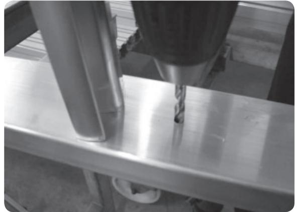
Die Kettensicherungen werden unterhalb der Stufen befestigt, wo die Gurtbänder befestigt waren.
