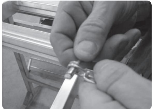
Die Kettensicherungen werden an den gleichen Stufen befestigt wie die Gurtbänder. Niete in die Bohrung einschieben.
