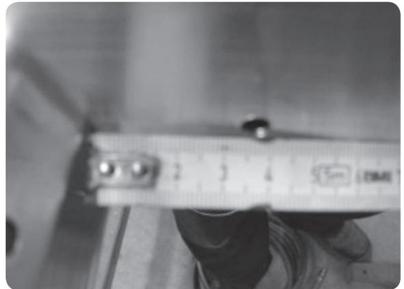
Schraube von außen durch den Seitenholm einschieben.
