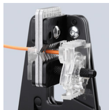
Sauberer Einschneiden der Isolation auf dem gesamten Umfang
