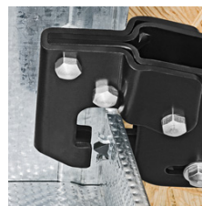
Das Stempelwerkzeug wird durch die Profilbleche gedrückt
