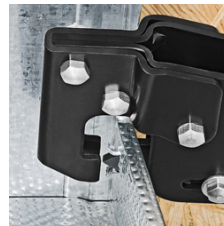
Das Stempelwerkzeug wird durch die Profilbleche gedrückt
