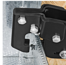
Das Stempelwerkzeug wird durch die Profilbleche gedrückt
