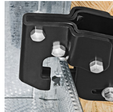
Das Stempelwerkzeug wird durch die Profilbleche gedrückt
