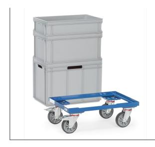
Eurokasten-Roller in offener Winkelstahlkonstruktion, pulverbeschichtet blau RAL 5007. 4 Lenkrollen mit TPE-Bereifung, Naben mit Rillenkugellager. 2 Stück mit Feststeller, gemäß der Europäischen Norm EN 1757-3 (Sicherheit von Plattformwagen). Passend für Eurokästen 600 x 400 mm.
