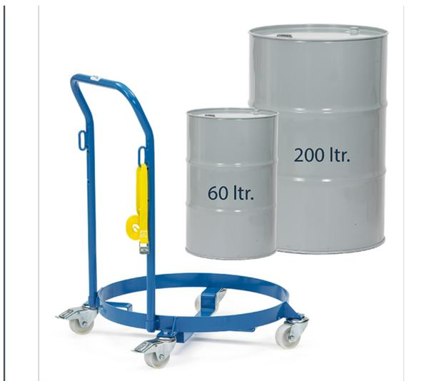
Fassroller für stehenden Transport von Stahlblechfässern mit 60 oder 200 Litern Inhalt. Verschweißte Stahlkonstruktion, pulverbeschichtet brillantblau RAL 5007, Kreuzstreben nach unten durchgekröpft Ø 420 mm für 60-Liter-Fässer, Außenring Innen-Ø 610 mm für 200-Liter-Fässer. Mit anschaubarem Rohrschiebebügel mit 2 Ösen und 1 Zurrurt. 4 Lenkrollen, 2 Stück mit Feststeller, Räder Polyamid, Naben mit Gleitlagerung.
