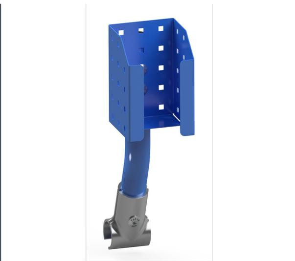
Halterung aus Stahlblech für Desinfektionsmittelflaschen, als Bausatz geliefert. Pulverbeschichtet blau RAL 5007. Mit variablen Anschraubpunkten an der Rückseite und den Seiten. Rohrstrebe vielfach gelocht, mit einer Klemmschelle zur Befestigung der Halterung beliebig positionierbar. Für handelsübliche Bode-Flaschen mit 500 ml Inhalt. (Flasche nicht im Lieferumfang enthalten)
