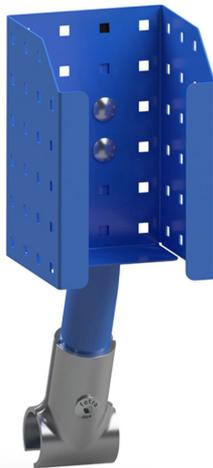
Halterung aus Stahlblech für Desinfektionsmittelflaschen, als Bausatz geliefert. Pulverbeschichtet blau RAL 5007. Mit variablen Anschraubpunkten an der Rückseite und den Seiten. Rohrstrebe vielfach gelocht, mit einer Klemmschelle zur Befestigung der Halterung beliebig positionierbar. Für handelsübliche Bode-Flaschen mit 1000 ml Inhalt. (Flasche nicht im Lieferumfang enthalten)
