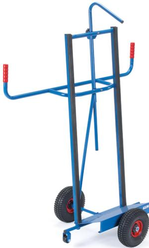
Stahlrohr-Konstruktion mit Stahlblechschaufel, Anlagen mit Profilgummi belegt (rutschsicher), und einstellbarem Niederhalter als Kippsicherung. Pulverbeschichtet blau RAL 5007. Räder mit Luftbereifung. Naben mit Rollenlager. 2 Stützrollen 50 mm Ø. Zerlegte Anlieferung. Zum Längstransport von großflächigen Holz- und Kunststoffplatten.
