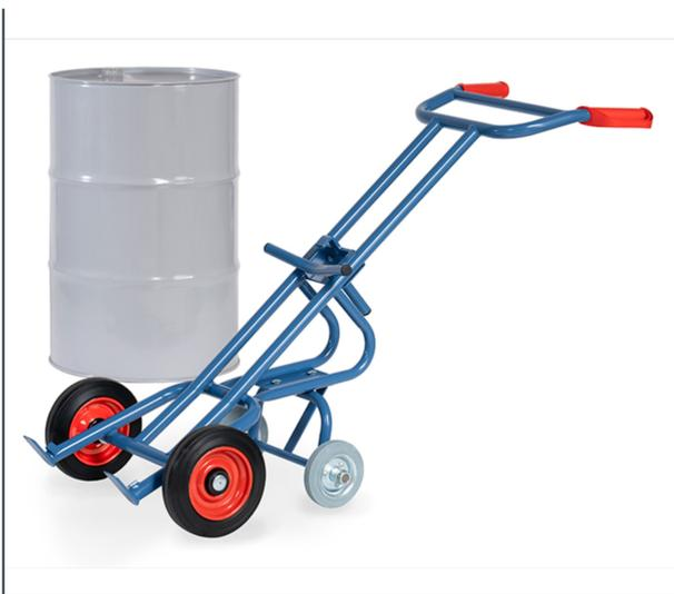
Fasskarre aus Stahlrohr geschweißt, pulverbeschichtet, blau RAL 5007, dauerhaft oberflächengeschützt. Räder mit Vollgummi-Bereifung, Naben mit Rollenlager. Für alle 200-Liter-Fässer mit Rand geeignet. Zusätzlich mit 2 Stützrädern Vollgummi 160 x 40 mm.
