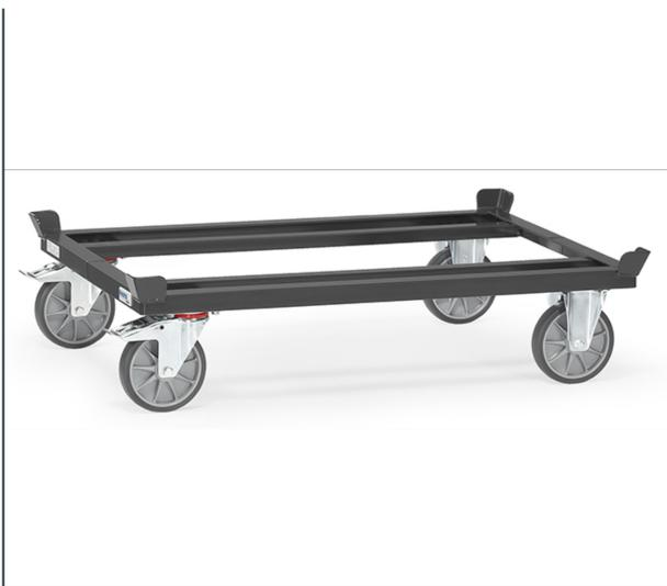
Für Flachpaletten und Gitterboxen. Robuste Winkelstahl-Schweißkonstruktion, mit 4 Fangecken, pulverbeschichtet, anthrazitgrau RAL 7016. 2 Lenk- und 2 Bockrollen, TPE-Bereifung, Naben mit Rillenkugellager, Feststeller an den Lenkrollen, gemäß der europäischen Norm EN 1757-3 (Sicherheit von Plattformwagen). Standard-Beräderung für mittlere Belastungen. Geräuscharmer Lauf.
