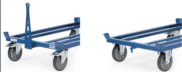
Deichsel und Kupplungzapfen für Paletten-Fahrgestelle. Für den Transport mit Zugfahrzeugen bis 6 km/h. Züge bis 5 Fahrgestelle möglich. Maximales Zuggewicht 2.000 kg. Deichsel aus Flachstahl, stellt sich mittels Gasdruckfedern selbsttätig in senkrechte Ruheposition. An der Bockrollenseite befindet sich ein stabiler profilierter Kupplungsbolzen. Verbindung durch Fußbetätigung möglich.
