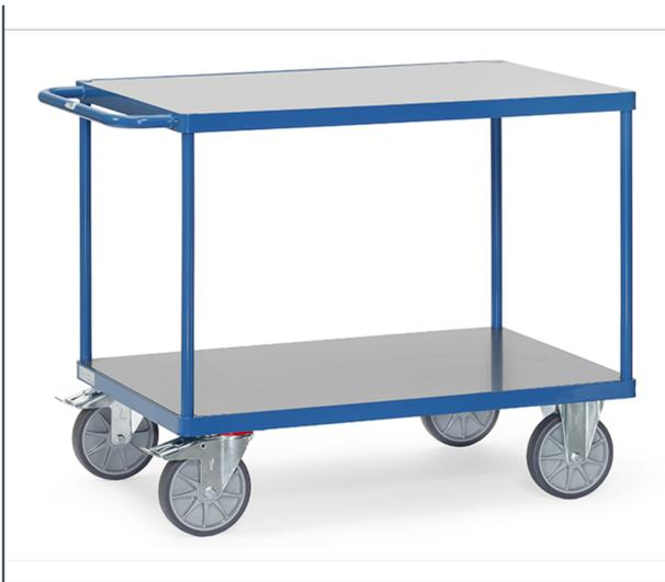
Stahlrohr und Profilstahl geschweißt, pulverbeschichtet RAL 5007. Mit zwei Plattformen mit Ladeflächen aus Hart-PVC. 2 Lenk- und 2 Bockrollen, TPE-Bereifung, Naben mit Rillenkugellager. Feststeller an den Lenkrollen, gemäß der Europäischen Norm EN 1757-3 (Sicherheit von Plattformwagen). Tragkraft obere Ladefläche 200 kg.
