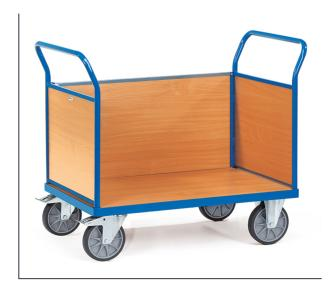
Stahlrohr und Profilstahl geschweißt, pulverbeschichtet RAL 5007, Plattform Holzwerkstoffplatte, Oberfläche Buchendekor. 2 Stirnwände und 1 Längswand aus Holzwerkstoffplatte, Oberfläche Buchendekor, Wände 500 mm hoch. 2 Lenk- und 2 Bockrollen, TPE-Bereifung, Naben mit Rillenkugellager. Feststeller an den Lenkrollen, gemäß der Europäischen Norm EN 1757-3 (Sicherheit von Plattformwagen).
