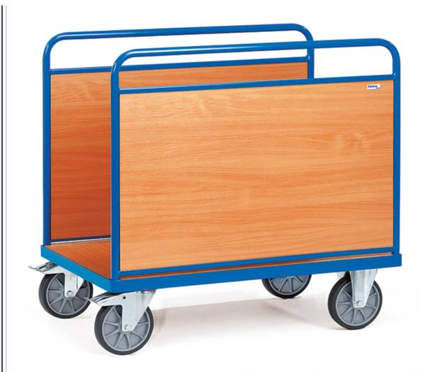
Ballenwagen aus Stahlrohr und Profilstahl geschweißt, pulverbeschichtet brillantblau RAL 5007. Mit Plattform aus Holzwerkstoffplatte und Oberfläche Buchendekor. Mit 2 Wänden aus Holzwerkstoffplatten, Oberfläche Buchendekor, Wandhöhe 620/750 mm. 2 Lenk- und 2 Bockrollen, TPE-Bereifung, Naben mit Rillenkugellager. Feststeller an den Lenkrollen, gemäß der Europäischen Norm EN 1757-3 (Sicherheit von Plattformwagen).
