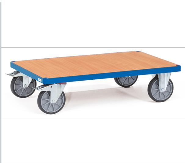
Profilstahl geschweißt, pulverbeschichtet RAL 5007, Plattform Holzwerkstoffplatte, Oberfläche Buchendekor. 2 Lenk- und 2 Bockrollen, TPE-Bereifung, Naben mit Rillenkugellager. Feststeller an den Lenkrollen, gemäß der Europäischen Norm EN 1757-3 (Sicherheit von Plattformwagen).
