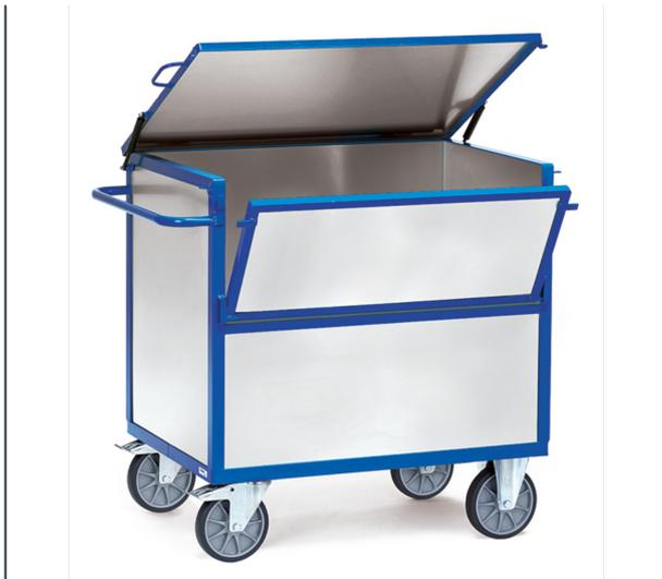
Stahlrohr und Profilstahl geschweißt, pulverbeschichtet blau RAL 5007. Boden aus Stahlblech, pulverbeschichtet. Winkelstahl-Konstruktion. Wände aus verzinktem Stahlblech, eingeklebt. Mit einteiligem Deckel, Hochstellung durch Gasdruckfedern. Ringösen für Vorhängeschlösser. 2 Lenk- und 2 Bockrollen, TPE-Bereifung, Naben mit Rillenkugellager. Feststeller an den Lenkrollen, gemäß der Europäischen Norm EN 1757-3 (Sicherheit von Plattformwagen). Zerlegte Anlieferung. Nutzhöhe: 816 mm.
