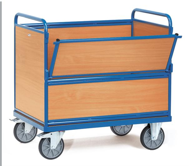
Stahlrohr und Profilstahl geschweißt, pulverbeschichtet blau RAL 5007. Boden aus Holzwerkstoffplatte, Oberfläche Buchendekor. Verschraubte Baukasten-Ausführung: Mit Stahlrohr-Aufbau, Wände aus Holzwerkstoffplatte, Oberfläche Buchendekor. 2 Lenk- und 2 Bockrollen, TPE-Bereifung, Naben mit Rillenkugellager. Feststeller an den Lenkrollen, gemäß der Europäischen Norm EN 1757-3 (Sicherheit von Plattformwagen). Zerlegte Anlieferung. Nutzhöhe: 700 mm.
