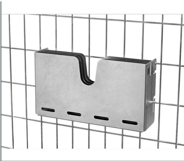
Dokumentenbox Stahlblech verzinkt. In Stirnwand einhängbar. Durch zwei einsteckbare Einteiler bis zu drei Fächer möglich. Ausgesparter Eingriffsbereich. Sichtfenster zur Beleganzeige. Innenmaße B x H x T: 320 x 170 x 41 mm (Fachtiefen bei Verwendung der Einteiler 13 mm)
