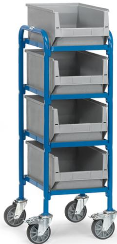
Baukasten-System: Stahlrohr- und Profilstahl geschweißt, pulverbeschichtet blau RAL 5007, Schraubkonstruktion. 4 Etagen mit Holzwerkstoffplatten, Rand 10 mm hoch und 4 Sichtlagerkästen (LxBxH: 500/450 x 310 x 200 mm). Tragkraft pro Ladefläche 60 kg. 4 Lenkrollen, TPE-Bereifung, Naben mit Rillenkugellager. 2 Stück mit Feststeller, gemäß der Europäischen Norm EN 1757-3 (Sicherheit von Plattformwagen).
