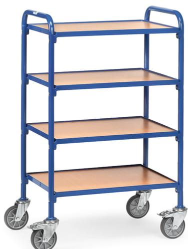
Baukasten-System: Stahlrohr- und Profilstahl geschweißt, pulverbeschichtet blau RAL 5007, Schraubkonstruktion. 4 Etagen mit Holzwerkstoffplatten, Rand 10 mm hoch. Tragkraft pro Ladefläche 60 kg. 4 Lenkrollen, TPE-Bereifung, Naben mit Rillenkugellager. 2 Stück mit Feststeller, gemäß der Europäischen Norm EN 1757-3 (Sicherheit von Plattformwagen).
