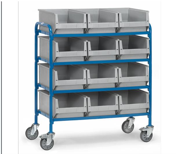
Baukasten-System: Stahlrohr- und Profilstahl geschweißt, pulverbeschichtet blau RAL 5007, Schraubkonstruktion. 4 Etagen mit Holzwerkstoffplatten, Rand 10 mm hoch und 12 Sichtlagerkästen (LxBxH: 500/450 x 310 x 200 mm). Tragkraft pro Ladefläche 60 kg. 4 Lenkrollen, TPE-Bereifung, Naben mit Rillenkugellager. 2 Stück mit Feststeller, gemäß der Europäischen Norm EN 1757-3 (Sicherheit von Plattformwagen).
