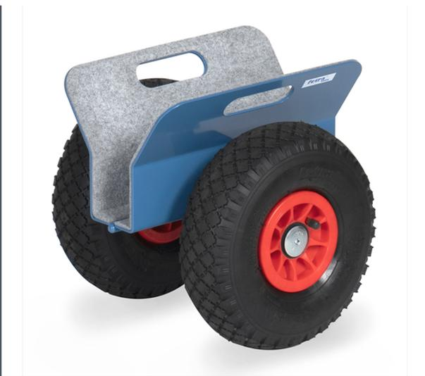
Stahl-Schweißkonstruktion, pulverbeschichtet blau RAL 5007, Klemmflächen mit Filzbelag. Sichere Klemmung durch das Gewicht des Ladegutes auf die Klappkonstruktion. Reifen mit Luftbereifung. Maximale Klemmbreite 0-60 mm.
