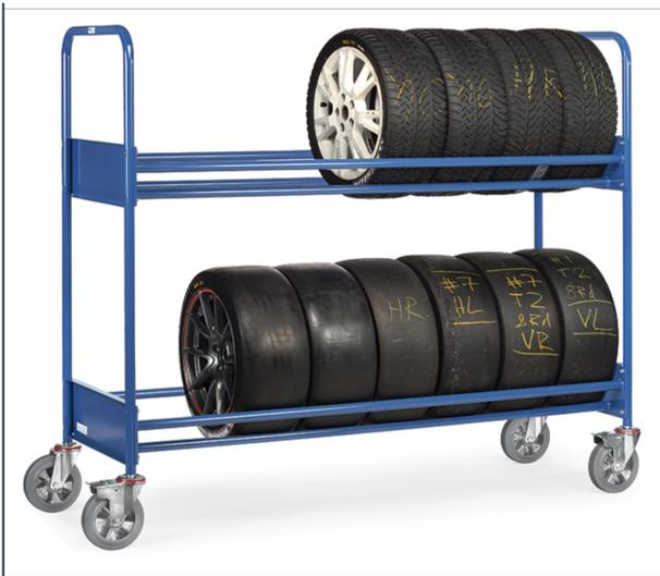
Stahlrohr-Konstruktion, verschraubt, pulverbeschichtet blau RAL 5007. 4 Lenkrollen mit Elastic-Bereifung blaugrau, spurlos, Naben mit Kugellager. 2 Stück mit Feststeller. Oberer Reifenträger um 75 mm verstellbar. Verstärkte Ausführung für den Einsatz mit hoher Beanspruchung, z. B. als Boxenwagen im Motorsport.
