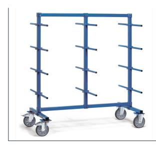
Rahmen aus stabilem Quadratrohr. Rollen-Traversen, Pfosten und Streben durch kräftige Schraubschellen verbunden. Tragarme aus Stahlrohr 27 mm Ø mit Schraubschellen. 24 Tragarme zweiseitig (12 Stück je Seite) Nutzlänge 370 mm. Pulverbeschichtet blau RAL 5007. Tragkraft pro Etage 120 kg (60 kg/Seite).2 Lenk- und 2 Bockrollen, TPE-Bereifung, Naben mit Rillenkugellager. Feststeller an den Lenkrollen, gemäß der Europäischen Norm EN 1757-3 (Sicherheit von Plattformwagen).
