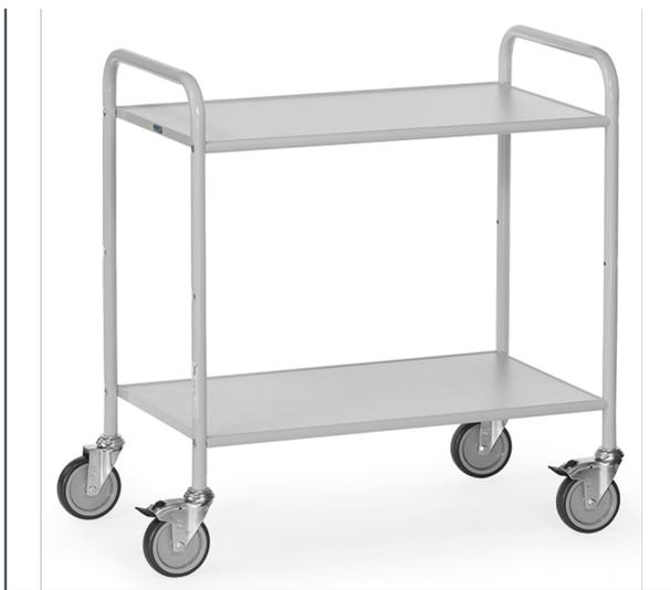
Baukasten-System: verschraubte Stahlrohr-Konstruktion, pulverbeschichtet in lichtgrau RAL 7035. 2 Böden aus Holzwerkstoffplatten, hellgrau. 4 Lenkrollen, Räder mit TPE-Bereifung, elastisch und leicht laufend, spurlos. Nabern mit Gleitlager. 2 Lenkrollen mit Feststeller, gemäß der Europäischen Norm EN 1757-3 (Sicherheit von Plattformwagen). Zerlegte Anlieferung, leichte Selbstmontage.
