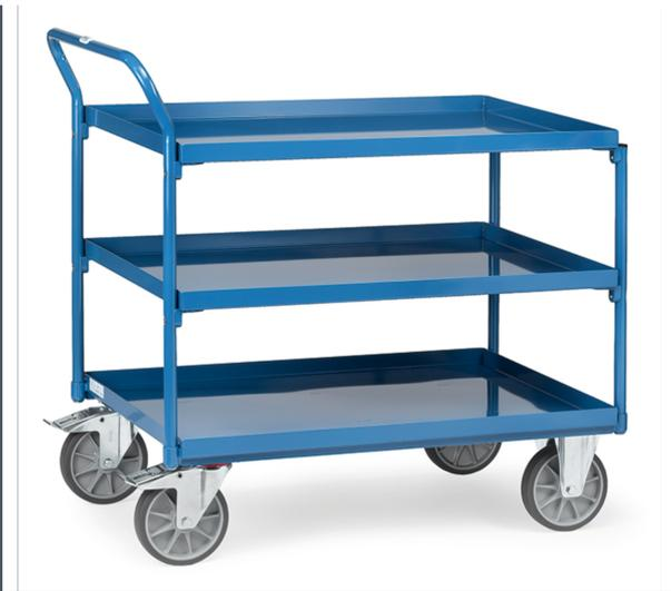
Tischwagen Stahlkonstruktion geschweißt. Mit 3 Stahlblechwannen. Stahlrohrbügel und Stahlblechwannen werden miteinander verschraubt. Wannen öldicht, Rand 40 mm hoch. Pulverbeschichtet brillantblau RAL 5007. Schiebegriff waagrecht. 2 Lenk- und 2 Bockrollen, TPE-Bereifung, Naben mit Rillenkugellager. Feststeller an den Lenkrollen, gemäß EN 1757-3 (Sicherheit von Plattformwagen). Tragkraft obere und mittlere Ladefläche 200 kg.
