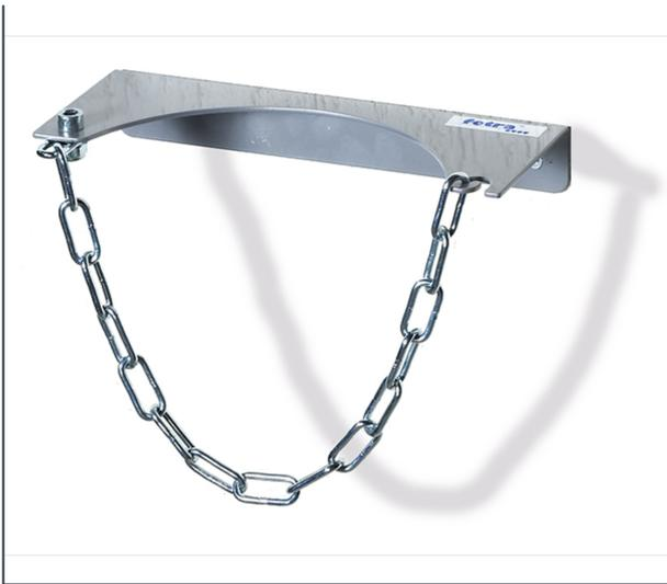
Stahlflaschen-Wandhalterung für 1 Stahlflasche mit 140 mm Durchmesser. Stahlblechkonstruktion, feuerverzinkt. Mit Kettensicherung und Bohrungen zur Wandbefestigung.
