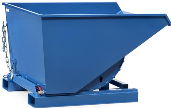
Selbstkipper müssen zum Entleeren nicht angehoben werden. Die leere Mulde geht selbsttätig in die Beladestellung zurück. Robuste Schweißkonstruktion aus 3-mm-Stahlblech, Lackierung blau RAL 5007. Serienmäßig mit Staplertaschen, Abrollsicherung und Kippverriegelung, Gliederkette als Abrutsch- und Kippsicherung. Zugseil zur Kippauslösung vom Staplersitz aus. Zusatz "A" bedeutet mit Ablasshahn und Sieb zum Trennen von Flüssigkeiten und Feststoffen.
