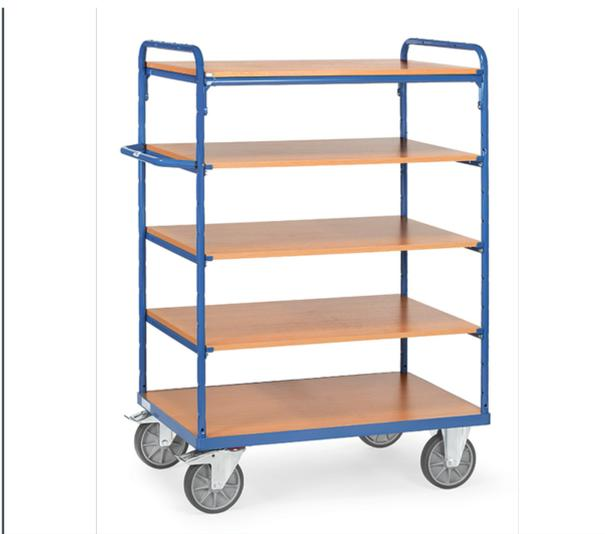
Baukasten-System: Aus Stahlrohr und Profilstahl geschweißt, pulverbeschichtet blau RAL 5007, Schraubkonstruktion. Stirnwände offen. 1 fester und 4 lose Einlegeböden aus Holzwerkstoffplatten, Oberfläche Buchendekor. Einlegeböden variabel einsetzbar, Teilung 100 mm. Tragkraft pro Einlegeboden 90 kg. 2 Lenk- und 2 Bockrollen, TPE-Bereifung, Naben mit Rillenkugellager. Feststeller an den Lenkrollen, gemäß der Europäischen Norm EN 1757-3 (Sicherheit von Plattformwagen).
