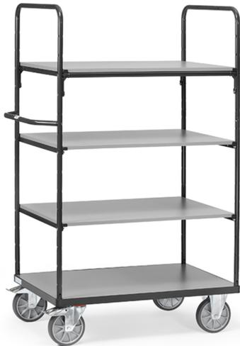
Baukasten-System: Aus Stahlrohr und Profilstahl geschweißt, pulverbeschichtet anthrazitgrau RAL 7016, Schraubkonstruktion. Stirnwände offen. 1 fester und 3 lose Einlegeböden aus Holzwerkstoffplatten, Oberfläche mittelgrau. Einlegeböden variabel einsetzbar, Teilung 100 mm. Tragkraft pro Einlegeboden 90 kg. 2 Lenk- und 2 Bockrollen, TPE-Bereifung, Naben mit Rillenkugellager. Feststeller an den Lenkrollen, gemäß der Europäischen Norm EN 1757-3 (Sicherheit von Plattformwagen).
