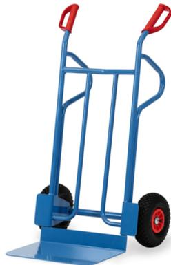
Stahlrohr-Sackkarre mit Stahlblechschaufel, stabile Schweißkonstruktion, pulverbeschichtet, blau, RAL 5007. fetra Sicherheitsgriffe. Stahlblechschaufel anschraubbar und dadurch austauschbar. Räder mit Luftbereifung, auf Kunststoff-Felgen, Naben mit Rollenlagerung. Zerlegte Anlieferung.
