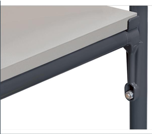
Diese Streben in anthrazitgrau werden einfach unter einer vorhandenen Etage verschraubt. Das stabilisiert den Aufbau und erhöht die Tragkraft der Einlegeböden. Der Boden, der über den Versteifungsstreben liegt, trägt durch die Unterstützung 150 kg anstatt 90 kg. 1 Paar wird pro GREY EDITION-Etagenwagen mitgeliefert.
