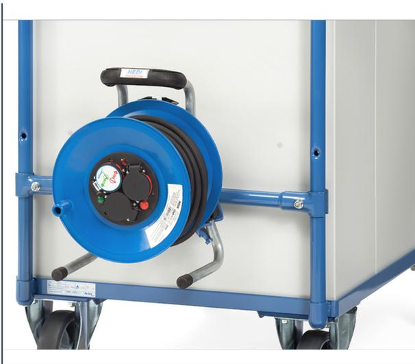
Kabeltrommel als Anbausatz für Leichte Tischwagen 700 mm breit. Pulverbeschichtet blau RAL 5007. Einfache Montage mittels Klemmschellen an den Stützrohren des Wagens. Nach VDE mit Thermoschutz. Feuchtraum-Ausführung mit 25 m Gummikabel 3 x 1,5. Abschließbar durch Vorhängeschloss (nicht im Lieferumfang enthalten). Für Modelle 4822, 4832, 4842, 4922, 4932
