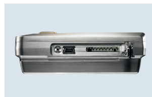
Seitlicher Anschluss von Mini-USB-Kabel und SD-Karte
