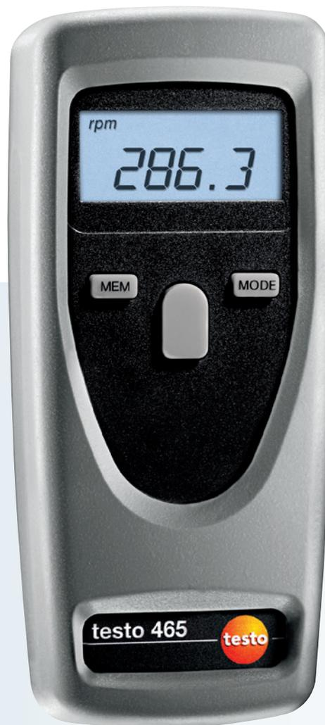
Mit dem testo 465 können Sie Drehzahlen ganz einfach berührungslos mit nur einer Hand messen. Das Messgerät eignet sich so beispielsweise für die Messung an rotierenden Teilen wie Ventilatoren und Wellen. Einfach eine Reflexmarke auf das Messobjekt kleben, den sichtbaren roten Lichtstrahl auf die Reflexmarke ausrichten und messen. Der Abstand zum Messobjekt beträgt dabei bis zu 600 mm.
