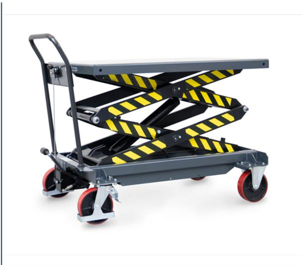
Hubtischwagen aus Profilstahl-/Stahlblech-Konstruktion, pulverbeschichtet anthrazitgrau RAL 7016. Kräftiger Rohrschiebebügel. Hydraulikpumpe mit verchromten Kolben. Betätigung über Fußpedal. Senkventil über Handhebel feinfühlig zu betätigen. Plattform 50 mm hoch. 2 Lenk- und 2 Bockrollen, Räder Polyurethan-Bereifung, Lenkrollen mit Feststeller. 2 Jahre Garantie
