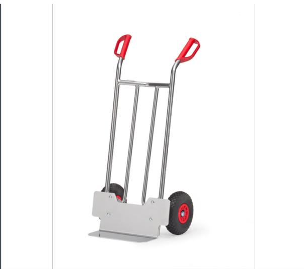
Sackkarre aus Aluminiumrohr mit Aluminiumschaufel, sehr leicht und handlich. Sauber verschweißt und "naturbelassen", Alublechschaufel anschraubbar und dadurch austauschbar. Mit pannensicherer PU-Bereifung auf Kunststoff-Felgen, Naben mit Rollenlagerung. Bügel oben und Querstreben durchgebogen. Für den sicheren Transport von runden Gütern, wie Rollen, Kannen, Eimern usw.
