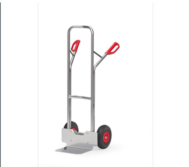
Aus Aluminiumrohr mit Aluminiumschaufel, sehr leicht und handlich. Sauber verschweißt und "naturbelassen", Alublechschaufel anschraubbar und dadurch austauschbar. Mit pannensicherer PU-Bereifung auf Kunststoff-Felgen, Naben mit Rollenlagerung. Bügel oben und Querstreben durchgebogen. Für den sicheren Transport von runden Gütern, wie Rollen, Kannen, Eimern usw.
