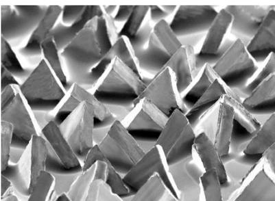
Basierend auf der keramischen Präzisionskorntechnologie generieren die 3M™ Trennscheiben eine exzellente Standzeit und ein schnelles Trennen. Die 3M™ Silver Trennscheiben halten auch länger als vergleichbare Zirkonkorund- oder Korund-Scheiben, so dass pro Scheibe mehr Schnitte möglich sind.
