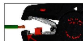
3 Werkzeug schließen bis es automatisch wieder öffnet. Korrekt abisoliertes Kabel entnehmen.
