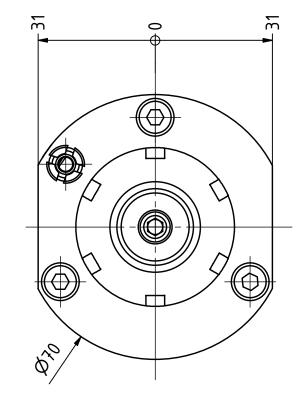
Spannzange / collet ER25 DIN6499 Spannbereich / clamping range: 1,0 - 16,0
