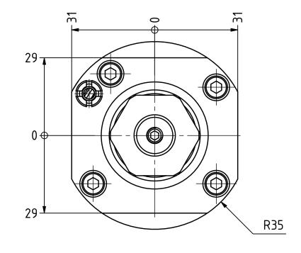
Spannzange / collet ER20 DIN6499 Spannbereich / clamping range: 1,0 - 13,0
