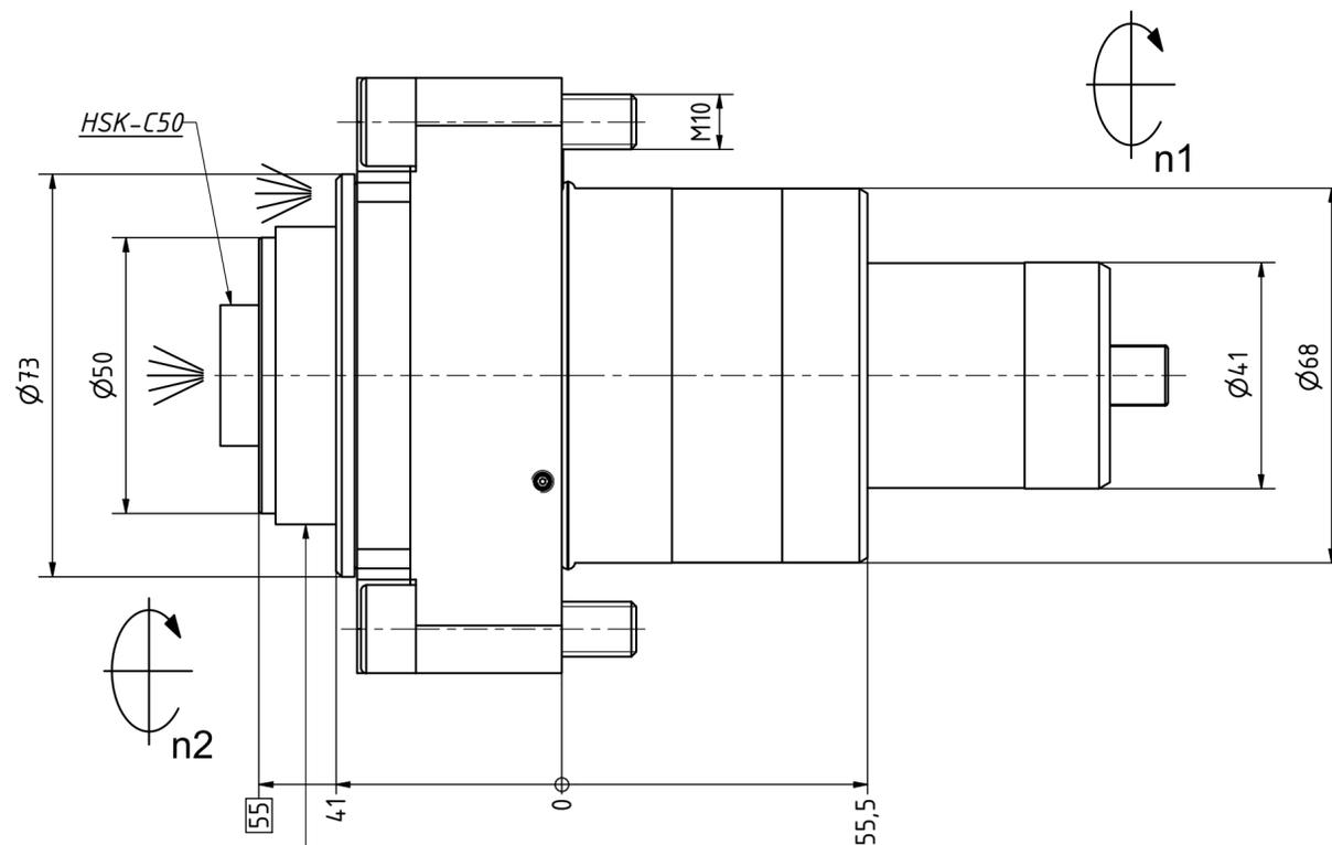
HSK-Befestigungsschraube in dieser Position zur Lage des Zweiflachs der Antriebswelle
