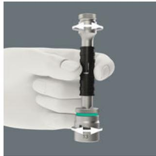
Die Verlängerungen der Top-Linien sind mit dem Flexible-Lock-System ausgestattet. Mit aktiviertem System können die Betätigungswerkzeuge dauerhaft auf der Verlängerung gesichert werden. Ungewollter Verlust des Werkzeugs oder Herausrutschen wird vermieden. Ist das System deaktiviert, können die Nusskörper wie gewohnt aufgesteckt und blitzschnell gewechselt werden.
