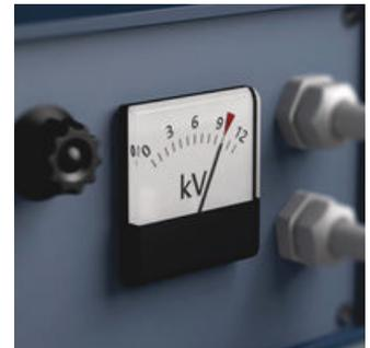
Die Prüfung des Werkzeugs auf Durchschlagsfestigkeit bei 10.000 Volt gibt dem Anwender die beruhigende Gewissheit, dass sein Schraubendreher auf seine wichtigste Eigenschaft, die Isolation, geprüft worden ist. Wera VDE-Schraubendreher werden Stück für Stück dieser Prüfung unterzogen. Sicheres Arbeiten bis 1.000 Volt ist somit garantiert.
