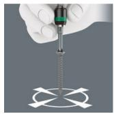
Die freilaufende Betätigungshülse erlaubt dem Anwender, den Akkuoder Elektroschrauber während des Schraubvorgangs an der Hülse zu führen. Das erleichtert das Ansetzen in der Schraube und verhindert Abrutschen. Auch als kurze Verlängerung bei ½" Anwendungen verwendbar z. B. in Kombination mit Wera Zyklop Knarren.
