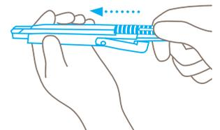
Zuletzt schieben Sie das Innenteil samt Klinge **in den Griff zurück** und klappen Sie das Griffende nach oben. Die Klinge testweise auslösen und wieder zurückschnellen lassen.
